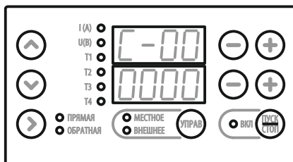
Рис 6 ПОКАЗАНИЯ ИНДИКАТОРОВ В РЕЖИМЕ НАСТРОЙКИ ПАРАМЕТРОВ ЦДУ
